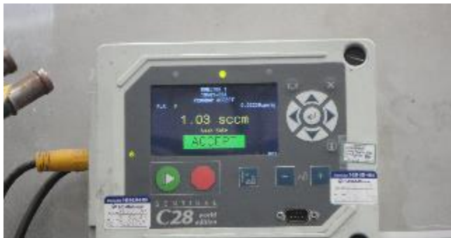
Ilustración 32. Pieza sin fugas Accept
