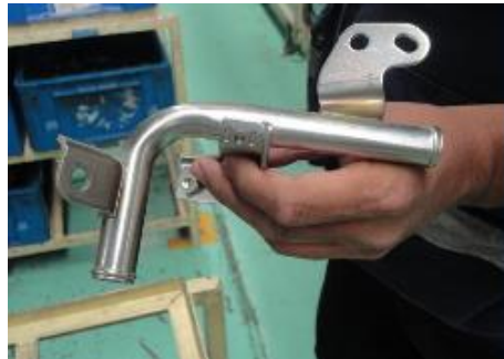
Ilustración 25. Pieza ensamblada por ajuste de presión
