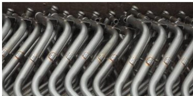
Ilustración 30. Pieza unida por anillo de cobre
