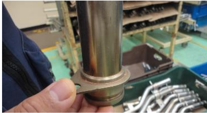
Ilustración 34. Pieza sin falta de cobre
